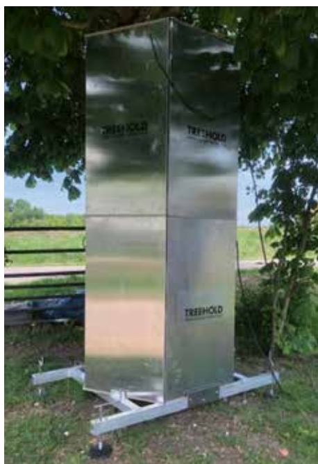
Het verschil tussen prototype 1 en prototype 2 is de behuizing, maar zit ook in de aanstuursoftware en het type infraroodpanelen. Momenteel werkt TreeHold met de industriële set.
