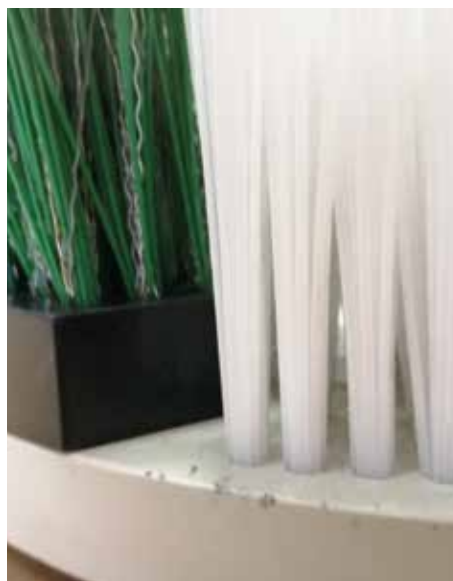
De groene, kortere blokken van de gepatenteerde borstel kan je na slijtage bijstellen.
