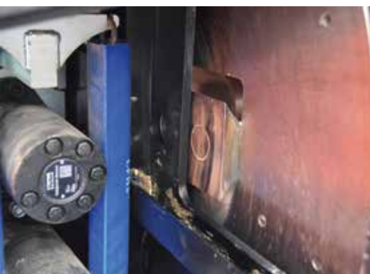
Een dikke, massieve pasbout garandeert de goede uitlijning bij herplaatsen van de korte messen
