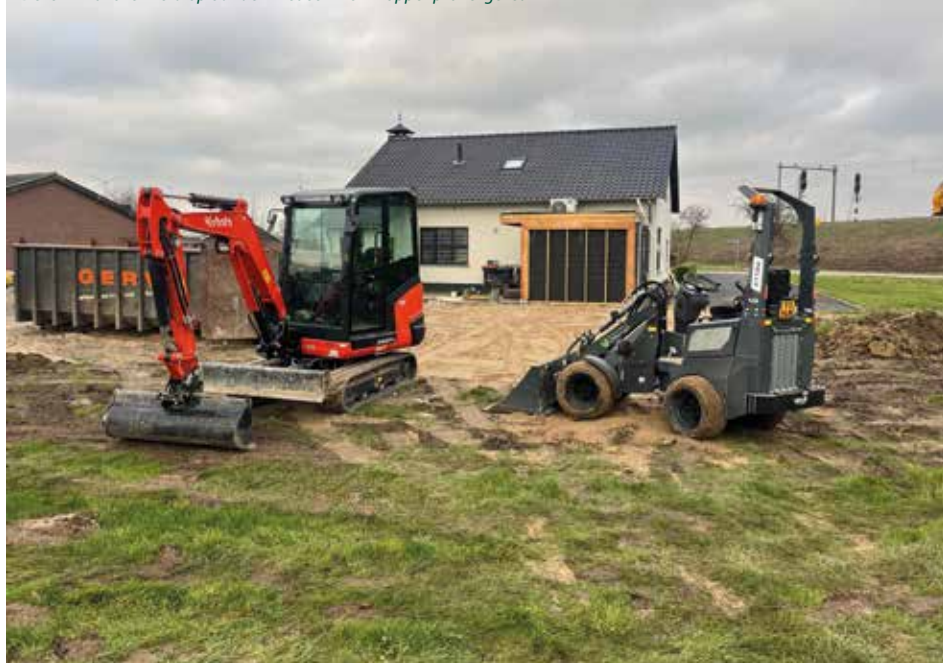
Deze minishovel werd op banden met een klein noppenprofiel gezet
