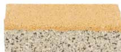
Zoak-klinkers zijn gemaakt van keramisch afval en kunnen veel water absorberen. (Beeld: Tuinvisie.nl)
