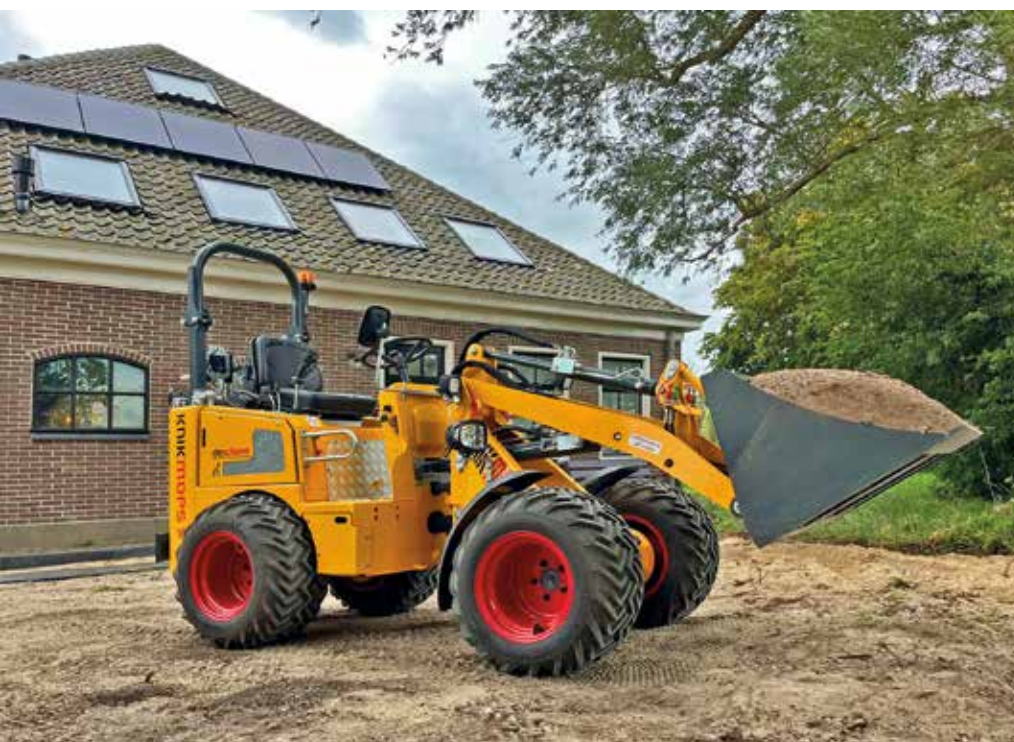
De Knikmops 140 mag meteen aan de bak, zowel letterlijk als figuurlijk. De Mitas 31-15.5-15-wielen en neerklapbare rolbeugel zijn optioneel.
