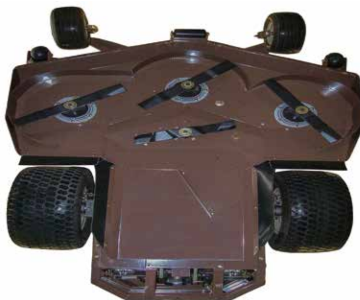
Het maaidek bezit naast de drie maaispindels nog een vierde spindel
