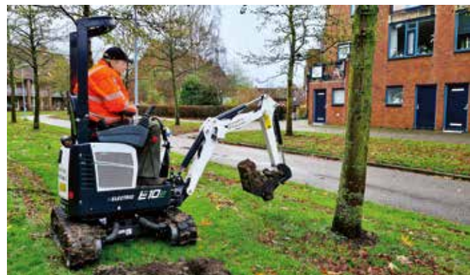
Ondanks zijn beperkte afmetingen heeft de E10E voldoende accucapaciteit voor een volledige werkdag.
