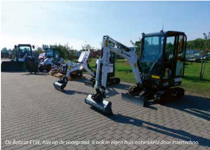
Aan de buitenkant van de E19E verraden alleen details de transformatie van diesel naar elektrisch.
