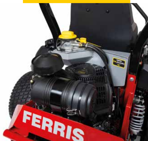
Motor van de ISX2200. Typierend zijn de grote vulopening en het oliefilter boven op de motor met de Oil Guard-olietank van 5 liter.
