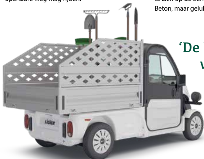
Het Ligier-bedrijfsvoertuig hier is voorzien van kantelbare zijwanden.
