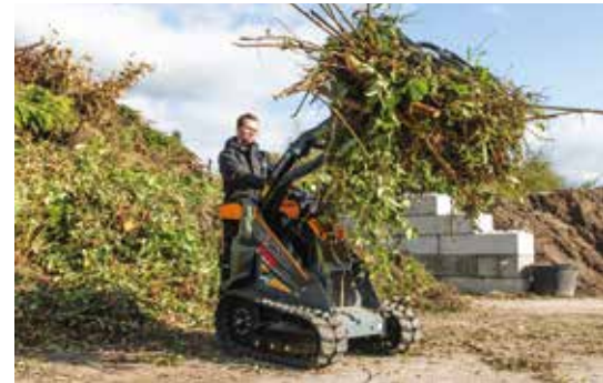
De nieuwe elektrische Skid op rupsen GS950TE. Met een gewicht dat begint bij 1.020 kg biedt de GS950TE extra tractie en duw-/trekkracht waardoor de bodemverdichting vermindert.
