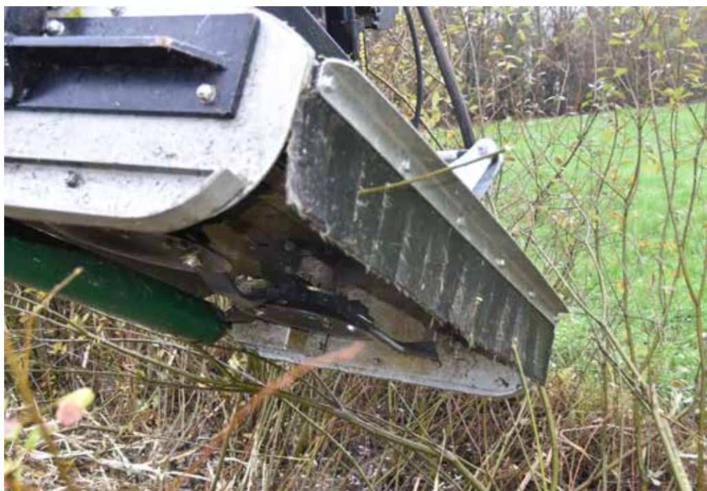
De hydraulisch bedienbare klep met rubberen flappen.
