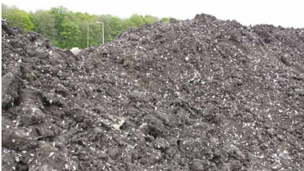
Klei vermengd met zand, veen, gesnipperd geotextieldoek en vochtbinder WaterXtra.
