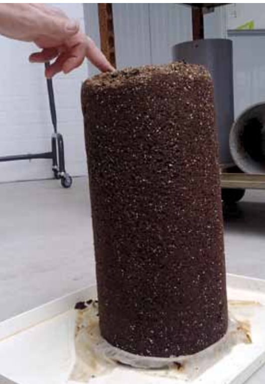
De kurkdroge opzuigkolom van 40 cm wordt vanuit natuurlijke retentie tot bovenin weer vochtig. Geen enkel ander substraat is hiertoe in staat; een uniek concept dus.
