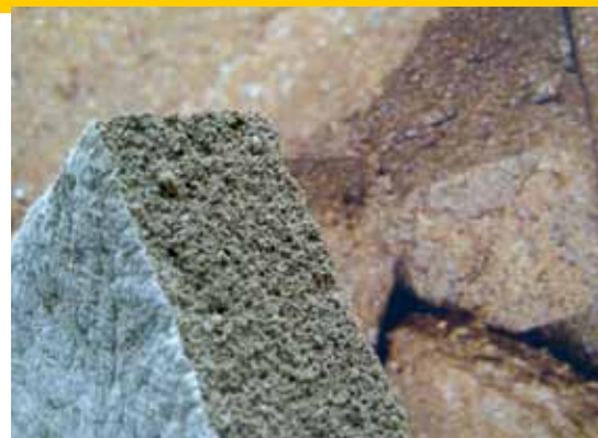
Doorsnede van een matje van 3 cm dik met een geotextiele rug.
